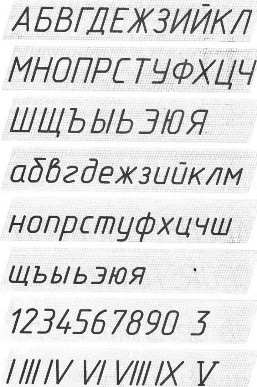
Рис. 25. Буквы и цифры чертежного шрифта
