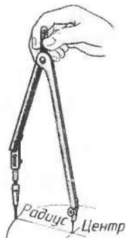
Рис. 16. Проведение окружности циркулем
