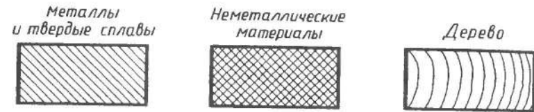
Рис. 198. Некоторые графические обозначения материалов
